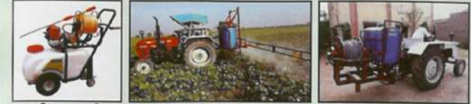
द्वाली युक्त शक्ति चलित छिड़काव यंत्र ट्रैक्टर वाहित बूम छिड़काव यंत्र ट्रैक्टर शक्ति चलित छिड़काव यंत्र
